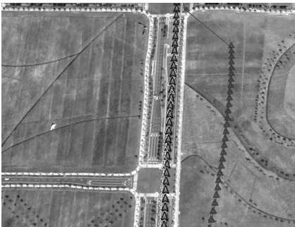
图 6 部分导航解算结果与基准位置的 Google Earth 截图,箭头符号表示基准位置,偏离较大的三角形符号表示无约束辅助的解算结果,偏离较小的三角形符号表示加入约束辅助的解算结果
